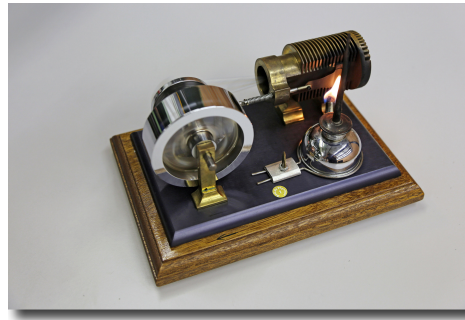
FIGURE 6.10 Moteur de Stirling : un brûleur rempli d'alcool à brûler chauffe l'air à l'intérieur d'un cylindre, fournissant ainsi de la chaleur au moteur qui est activé par le lancement du volant d'inertie. Moteur à dépression : moteur à air chaud qui aspire la flamme au moyen d'une soupape (bruit caractéristique)
